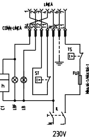
Рис. 19: Горелки одноступенчатые
