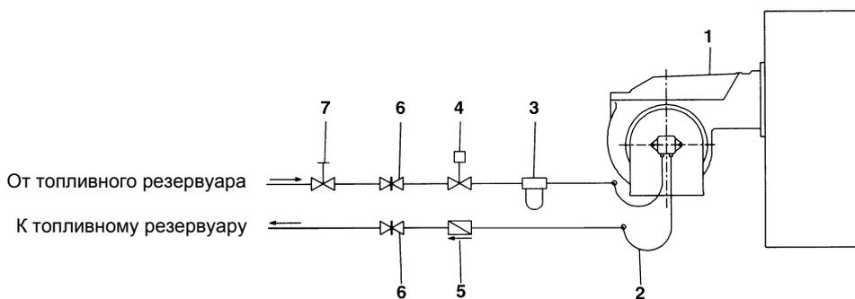
Рис. 21 - Двухтрубная система
