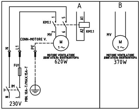
(#) MOTORE VENTIL. 620W, FU2 = 6,3A F; MOTORE VENTIL. 370W, FU2 = 10A F
